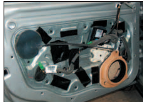
Sitzprobe: Die neue Lautsprecheraufnahme wird angepasst.
