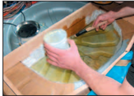
Laminat: Damit das Subwoofergehäuse perfekt sitzt, laminiert man die Ersatzradmulde aus.
