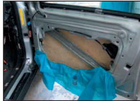
Pasta: Das Türblech wurde mit Dämmpaste ruhig gestellt.
