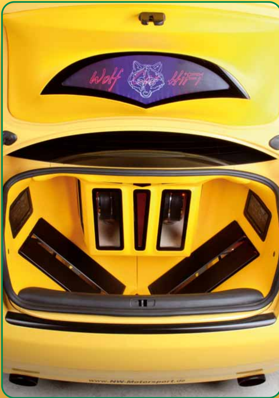
Es war Millimeterarbeit, die zwei großen Etons (und die GFK-Teile) in das Gepäckabteil zu bekommen. Die Reserveradmulde wird komplett genutzt, was dem Einbau effektiv Tiefe verleiht
