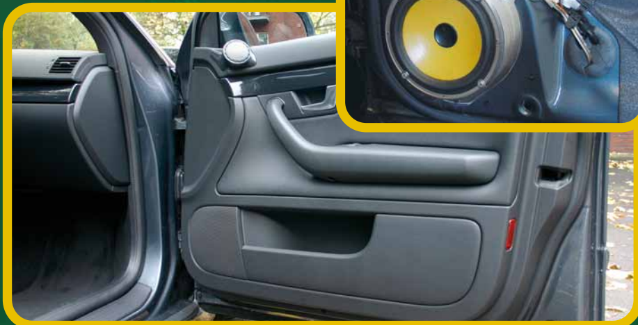
Die Tief-/Mitteltönen Powerpakete stecken in den Originalöffnungen der Türen
