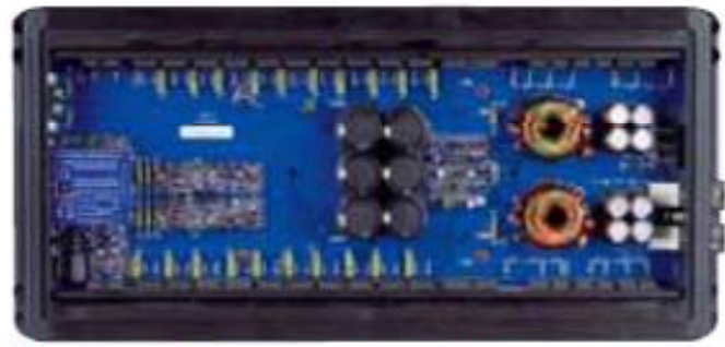
Modern und aufgeräumt dank SMD-Bestückung: Die neue Eton ECC geizt nicht mit optischen und technischen Reizen. Die Frequenzweichen taugen dank x10-Schalter für alle möglichen Anwendungen
